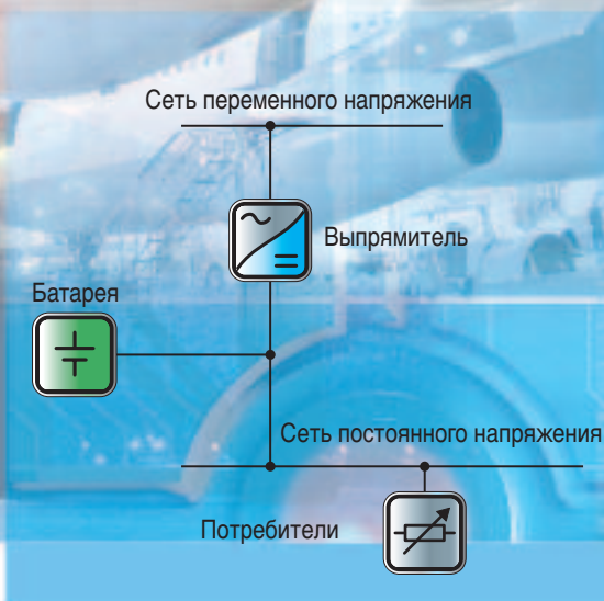
Рис.2. Режим дежурной параллельной работы
